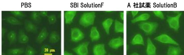
1次抗体・2次抗体を3種の条件で希釈し反応させた結果、Signal Booster ImmunostainはPBSより強い染色を示し、類似試薬と同等以上の染色増強能を示した。
