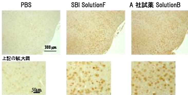
1次抗体を3種の条件で希釈し反応させた結果、Signal Booster ImmunostainはPBSより強い染色を示し、類似試薬と同等以上の染色増強能を示した。
